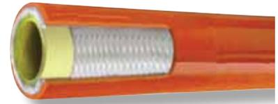
黄色聚烯烃管、单层高强度合成纤维编织加固材料和耐磨、光滑的橙色聚醚氨酯套。
