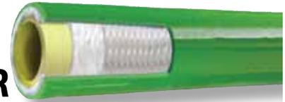
黄色无缝热塑管、双层高强度合成纤维编织加固材料和耐磨、光滑的绿色聚醚氨酯套。
