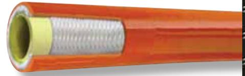
黄色聚烯烃管、单层高强度合成纤维编织加固材料和橙色耐磨聚醚氨酯套。
