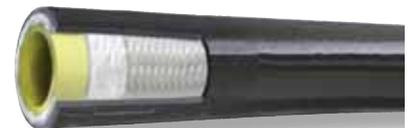
黄色无缝热塑管、双层高强度合成纤维编织加固材料和耐磨、光滑的黑色聚醚氨酯套。
